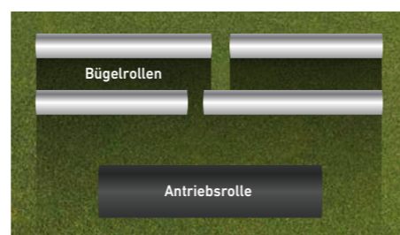
Versetzte Bügelrollen für eine perfekte Grünsoberfläche mit einer exzellenten Spurtreue des Balls
