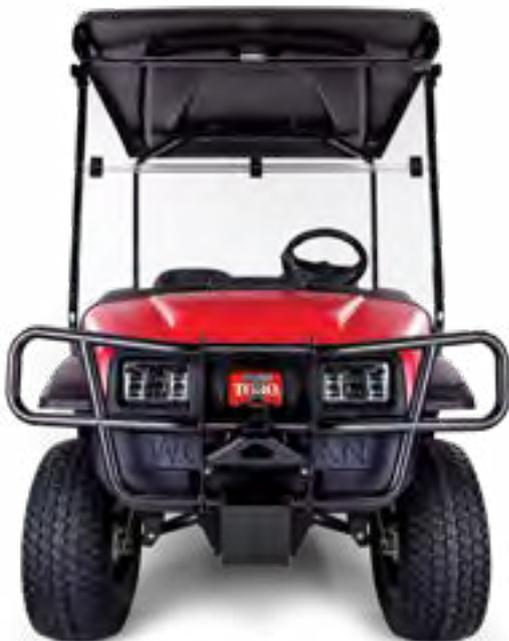
Workman GTX EFI mit mehr Bodenfreiheit
