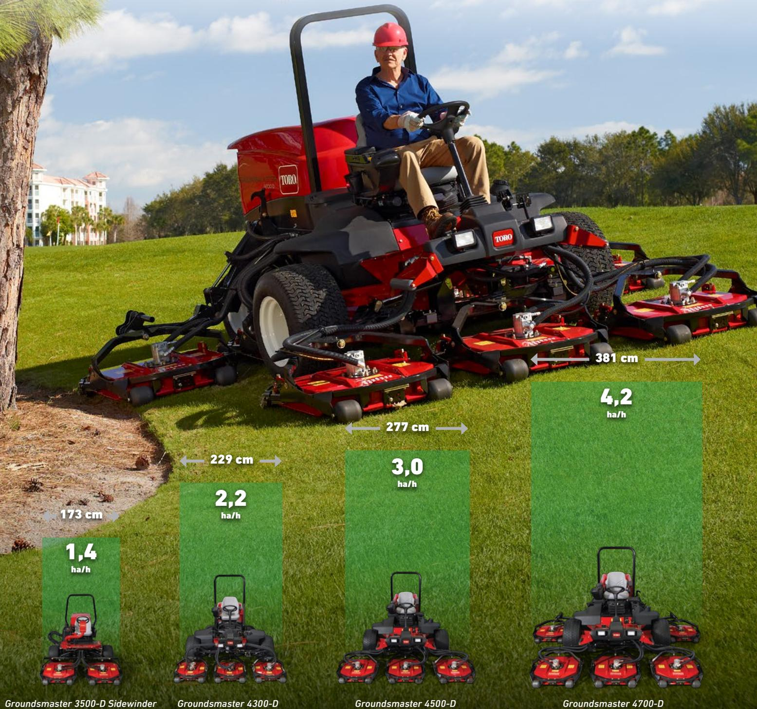
Die Produktivität pro Stunde hängt vom Bediener und dem Rasenzustand ab. Setzt Effizienz von 85 % für Wenden und Überlappen voraus.
