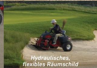
Hydraulisches, flexibles Räämschild
